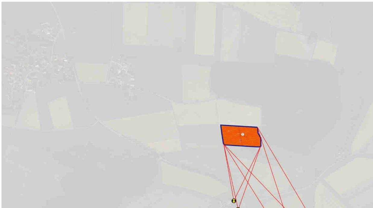
Von der weiter südöstlich liegenden Bebauung von Engleshof aus können bei freien Sichtachsen zu den Moduloberflächen Beobachter-Azimutwinkel zwischen ca.  $136^\circ$  Südost und  $162^\circ$  Südsüdost bei Beobachter-Elevationswinkeln zwischen ca.  $+0,1^\circ$  und  $+0,3^\circ$  vorliegen.
